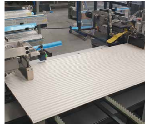
Machine pour la coupe et l'assemblage des tabliers de volets roulants en ALU
