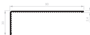
NEW CE2425C Cornière 90x30x2,4 crantée 5 barres de 6 ml / paquet 400 barres de 6 ml / container
