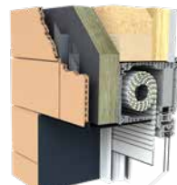
Pose sur maison ossature bois
