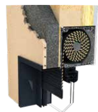
Pose sur maison ossature bois
