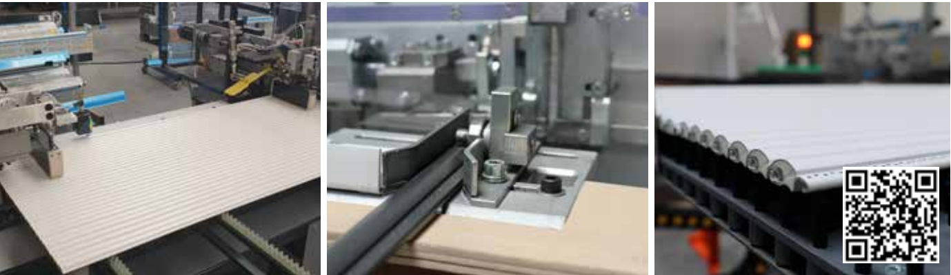
Machine pour la coupe et l'assemblage des tabliers de volets roulants en ALU Agrafeuse manuelle Agrafeuse automatique
