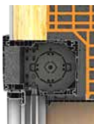
Pose en demi- linteau (R+1 accès par la trappe intérieure)
