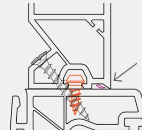
Joint d'étanchéité intégré aux tapées
