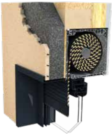
Coffre FoKus 235 - Montage ossature bois Lame bioclimatique® ALU gris anthracite 7016
