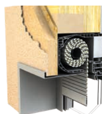
Pose sur maison ossature bois
