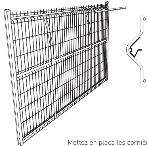
Mettez en place les cornières de verrouillage dans le pli supérieur de la grille, languette en bas.
