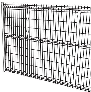
Une fois les cornières positionnées, insérez le haut des occultants entre la cornière de verrouillage et les fils horizontaux en les cintrant, jusqu'à les clipper sur la languette.
