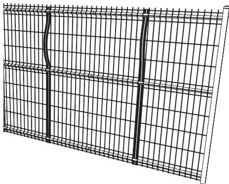
Une fois les cornières positionnées, insérez le haut des occultants entre la cornière de verrouillage et les fils horizontaux en les cintrant, jusqu'à les clipper sur la languette.
