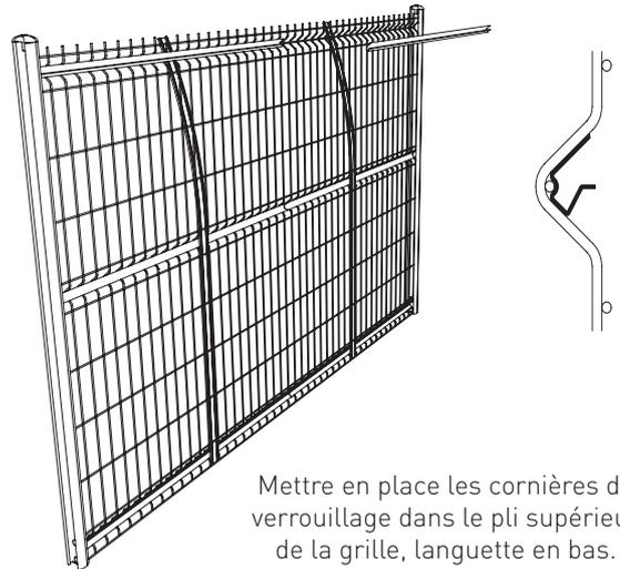
Mettez en place les cornières de verrouillage dans le pli supérieur de la grille, languette en bas.
